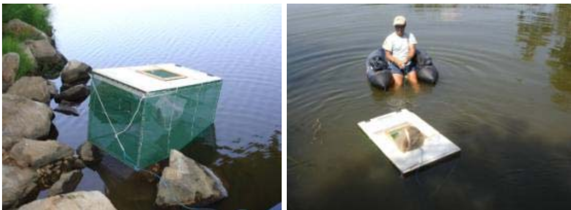
Imagen 8 & 9: Nasa flotante antes de ser introducida en el río y una vez introducida para ser posicionada
