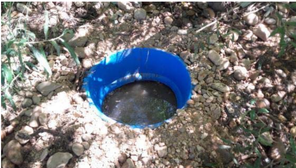
Ilustración 15: Cubo sin fondo e inundado por las filtraciones de la capa freática del río
