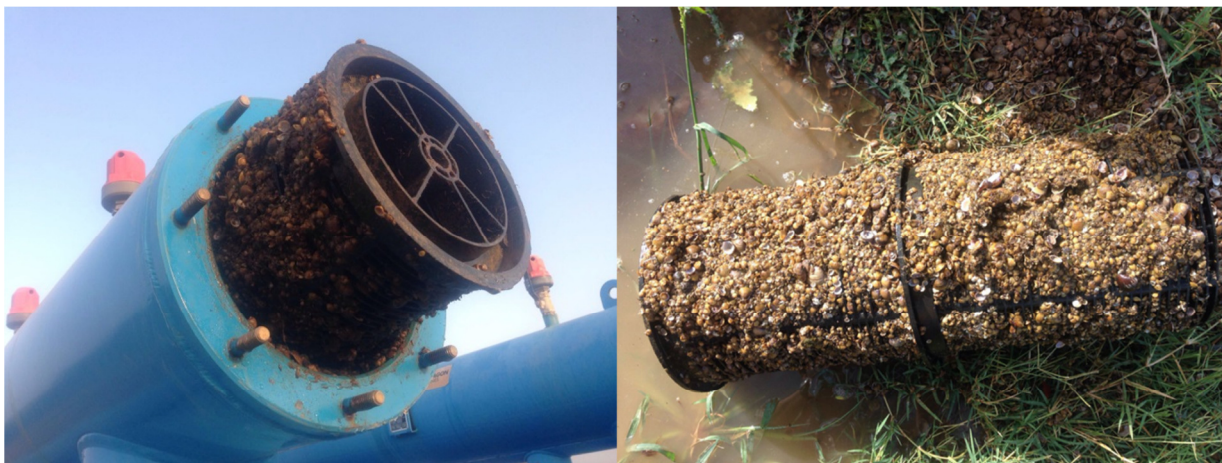
Foto 2: Almeja asiática taponando los prefiltros colocados en hidrantes intermedios del sector e1 a .
