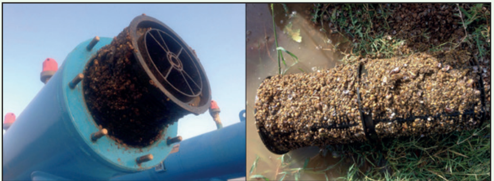
Ilustración 30: Almejas asiáticas taponando las infraestructuras de riego.
